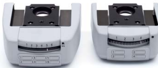
Auswechselbar: das Standardlinsensystem und das Achromatisierungssystem für Mehrkanal-Fluoreszenz-Applikationen.
