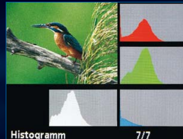
Die einblendbare Histogrammanzeige erlaubt eine exakte Belichtungskontrolle.
